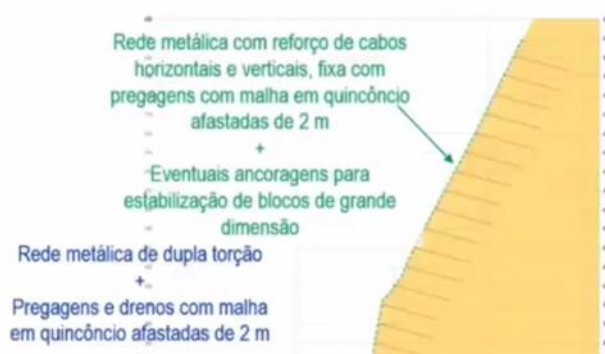
Figura 4.91 – Estabilização de taludes de natureza rochosa
